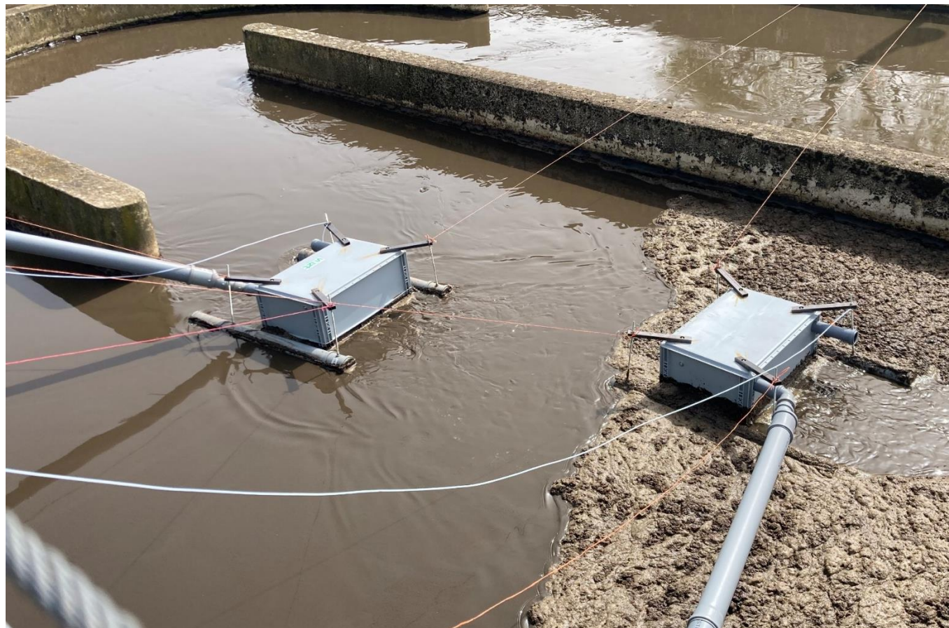
Obr. 1: Umístění dvou komor v oběhové aktivaci, duben 2024
