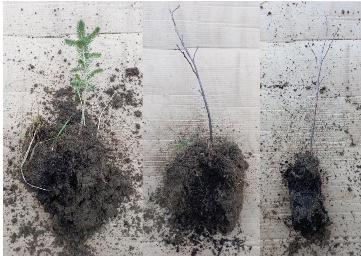
Zleva zcela rozložené obaly z kartonu a nasávané kartonáže a nesoudržný obal z kancelářského papíru s viditelným obrysem po jedné vegetační sezóně v půdě.
