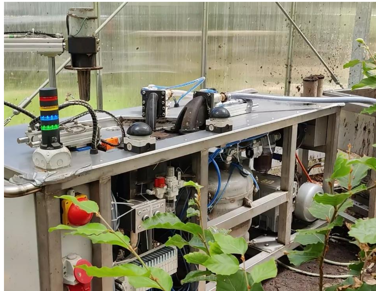
Poloautomatické zařízení na obalování prostokořenného sadebního materiálu do prorůstavých obalů z recyklovaného papíru.
