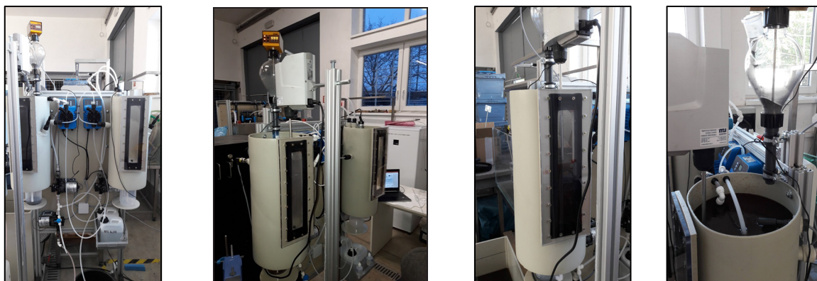
Obr. 1 Čtvrtprovozní zařízení pro ověření účinnosti technologie na reálných vzorcích vod
